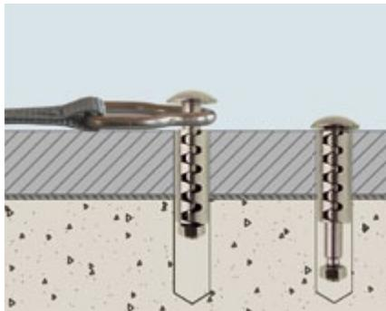
Wenn der Rollschutz entfernt ist, befinden sich die Stifte der Bodenanker vollständig versenkt in den Beckenrandsteinen – es besteht somit keinerlei Verletzungsgefahr.
